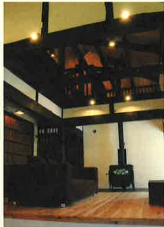
【リビング】ロフトにつながる吹き抜けをつくりリビングは大空間に。薪ストーブを入れることで冬も暖かい。天井と床には断熱材(スタイロフォーム)を入れ、従来の古民家の寒さを軽減した。明るくするため高窓も新設した。
