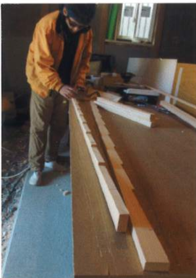
長方形の材を棧の形に加工
