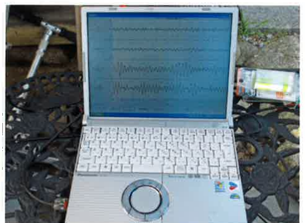
パソコンにグラフが表示され、建物と地盤の 振動の様子を見ることが出来ます。
